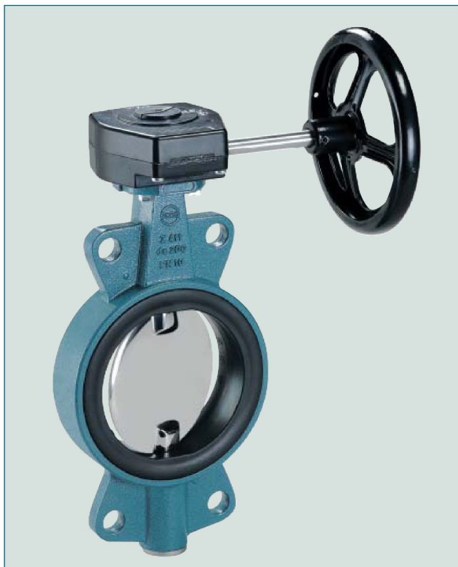
Centricky uložená mezipřírubová klapka s měkkým těsněním s redukovaným vnitřním průměrem pro potrubí PE/PP.
